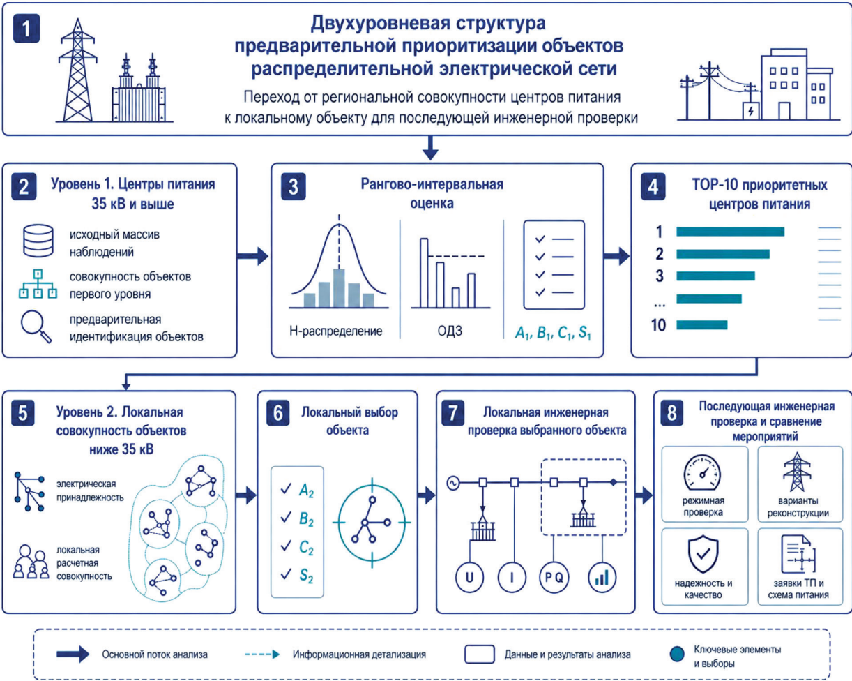
Рис. 1. Двухуровневая структура предварительной приоритизации объектов распределительной электрической сети Источник: составлено автором
