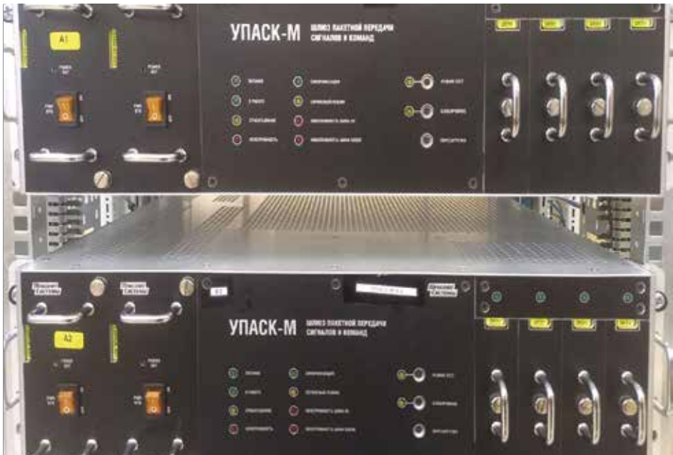
Устройство УПАСК-М для приема и передачи R-GOOSE, разработанное в ходе НИОКР
