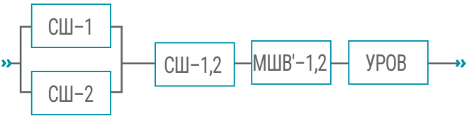
Рис. 5. Диаграмма надежности схемы для погашения всего РУ
