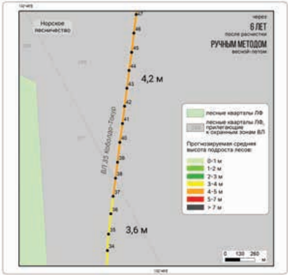
Рис. 7. Пример визуализации результатов определения на участке ВЛ 35 кВ Коболдо–Токуро прогнозируемой средней высоты подростка лесов, достигаемой им через шесть лет после расчистки ручным методом весной–летом (а) и рекомендуемой периодичности расчистки ДКР на просеках ВЛ ручным методом весной–летом (б)
