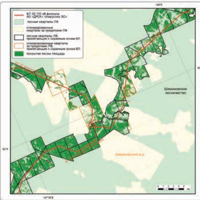
Рис. 4. Пример визуализации покрытой лесом площади в границах лесных и условных кварталов, прилегающих к охранным зонам участков ВЛ 35 кВ Шимановск–Георгиевка и ВЛ 35 кВ Шимановск–Мухино
