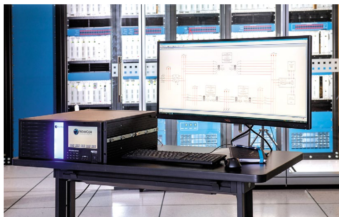
Рабочее место оператора симулятора RTDS для моделирования в реальном времени электроэнергетических систем (Исследовательский центр силовых систем RTDS Technologies, Канада)
