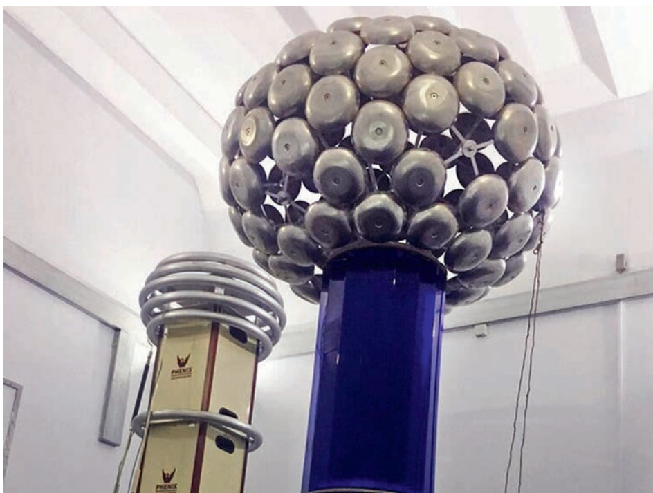
Прошедший совершенствование Государственный первичный специальный эталон единицы электрического напряжения постоянного тока — вольт в диапазоне \pm (1 \dots 500) кВ (фото: ВНИИМС)
