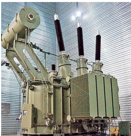
Трансформатор класса напряжения 220 кВ в испытательном центре завода «СМТТ. Высоковольтные решения» (фото: «СМТТ. Высоковольтные решения»)
