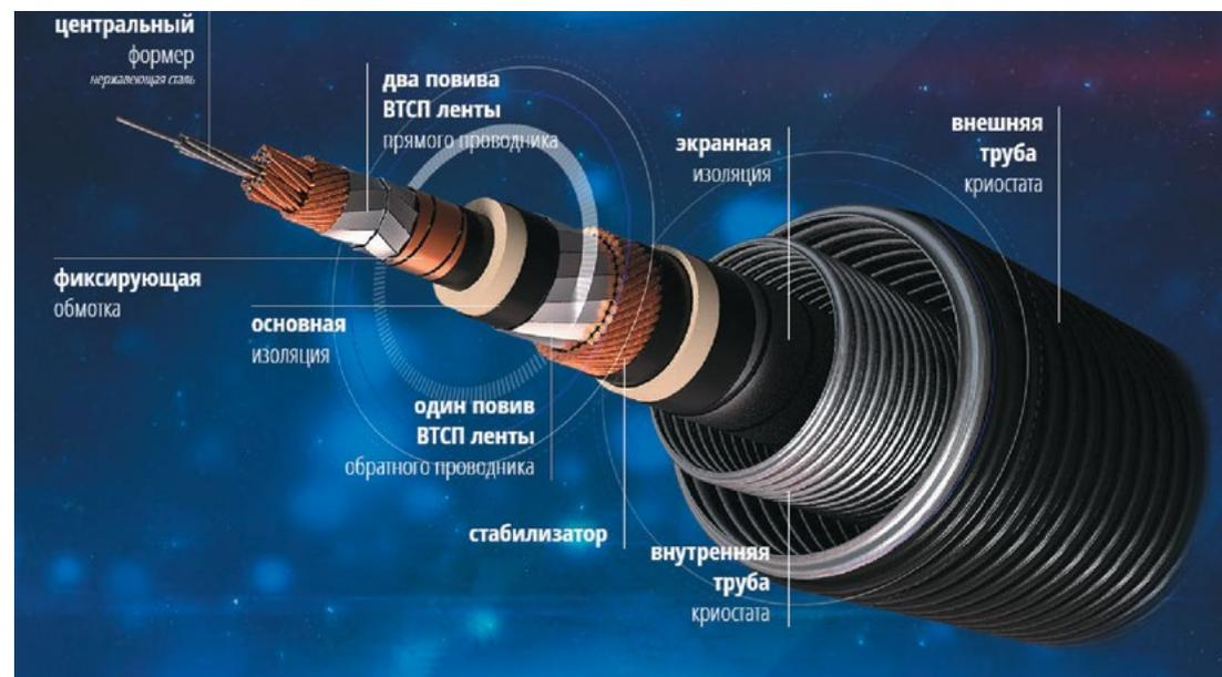
Структура высокотемпературного сверхпроводящего кабеля постоянного тока
