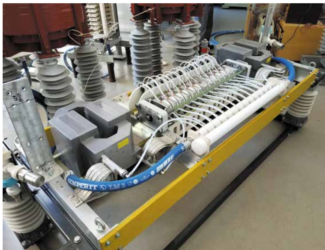
Внешний вид высоковольтного тиристорного модуля блока вентильного преобразовательного моста (ВТМ БВПМ-М)
