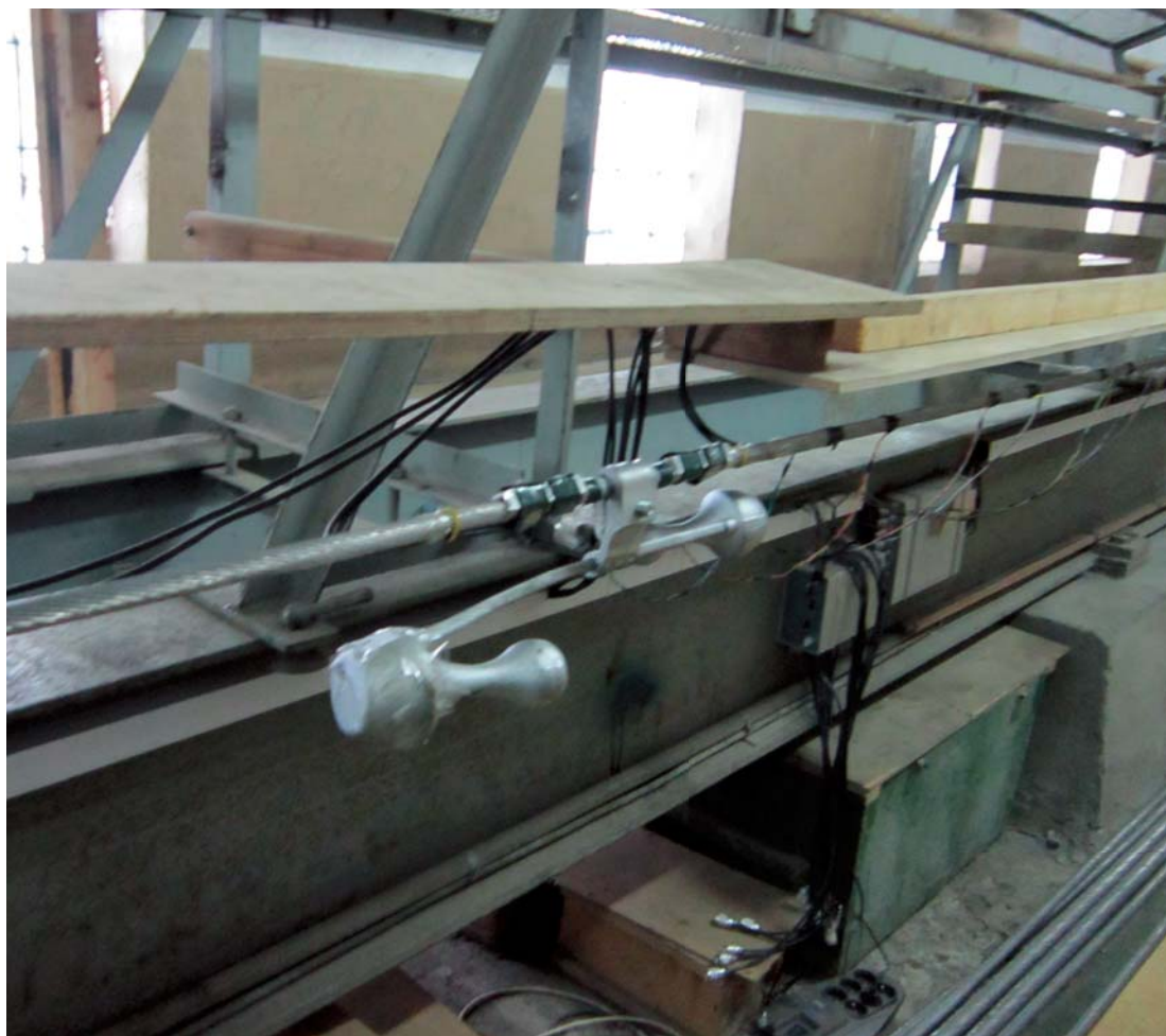
Общий вид гасителя вибрации ГВМ(У)-1,6/2,4-16/20 на испытательной установке в АО «НТЦ ФСК ЕЭС»
