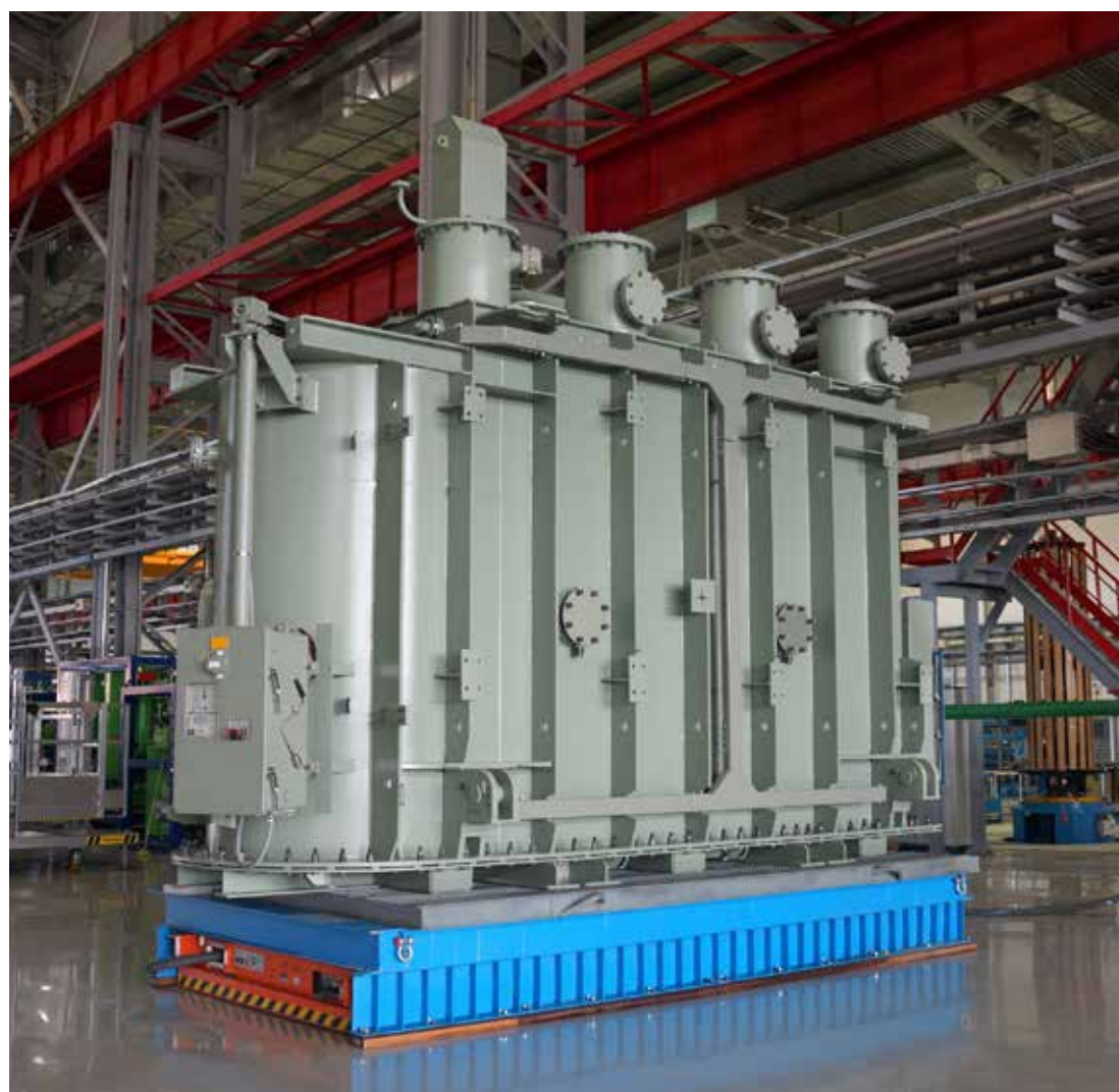
Современный силовой трансформатор с масляной изоляцией в производстве
