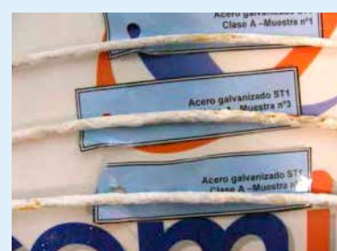
Фото 2. Провода со следами красной коррозии на образцах из оцинкованной стали ST1, класс А, после 1000 ч. испытаний.
