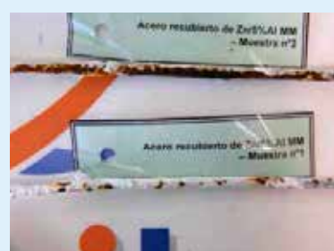
Фото 3. Провода со следами красной коррозии на образцах из стали, покрытой цинком, 5% Al MM, после 1840 ч. испытаний.
