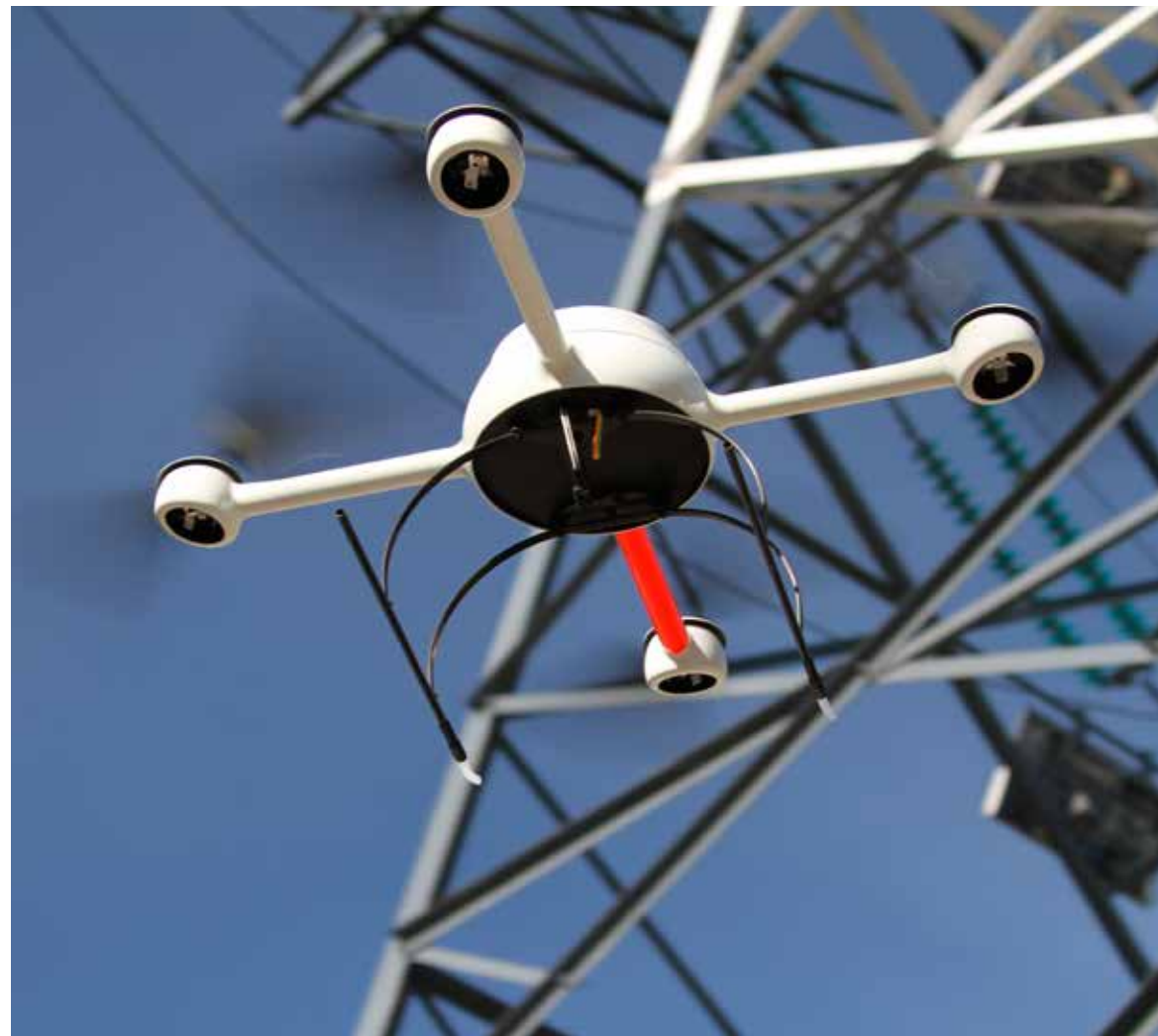
Рис. 6. Внешний вид беспилотного летательного аппарата вертолетного типа
