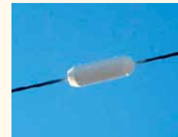
б) устройство ДИМ (дистанционный измерительный модуль) для измерения температуры, положения и величины тяжения провода
