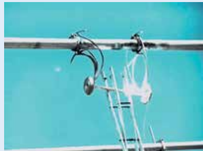
Слабое дугообразование при действующем значении тока 80 кА и кратковременном 130 кА в течение 1 с (испытания кратковременным током)
