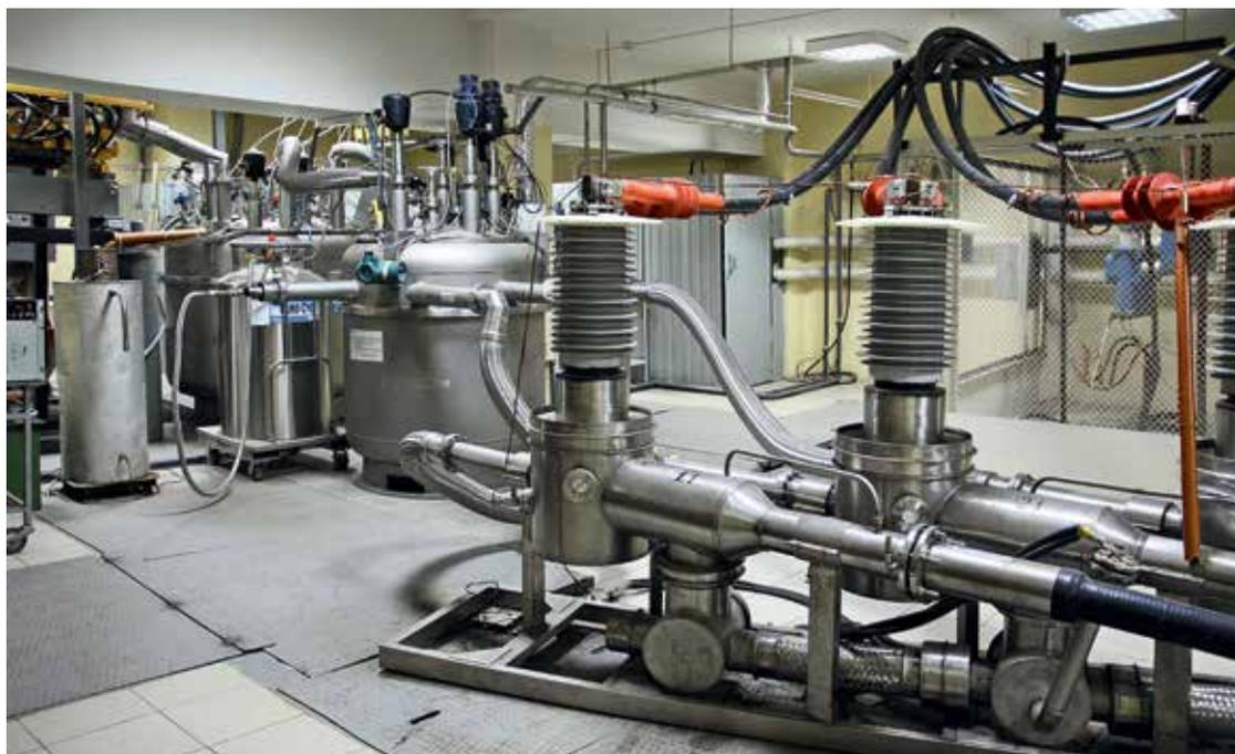
до 2,5–3,0 м<sup>3</sup> на фазу, что даст возможность реализовать его многократное включение, т. е. реализовать режим АПВ. Технические параметры ТООУ-220 на основе быстродействующих коммутаторов взрывного типа позволяют утверждать, что именно эти устройства могут быть наиболее перспективными для применения глубокого токоограничения в сетях всех классов напряжения. Внедрение ТООУ на ПС 500 кВ «Каскадная» намечено на 2016 г.
