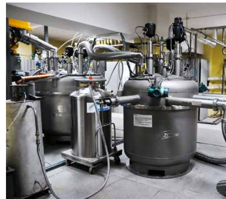
Криогенная установка для испытания кабеля ВТСП
